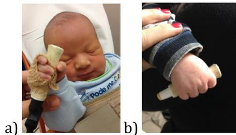
Figura 3- a) Cilindro com sensor de pressão posicionado na mão do sujeito afixado com coban. b) cilindro sem o sensor e fixação.
